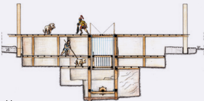
Εικ. 9 (α) Ο υπόγειος χώρος της αρένας, (β) η κάτοψή του και (γ) η αναπαράσταση του μηχανισμού με τον οποίο ανέβαζαν τα θηρία στην αρένα (Γ. Καραδέδος).
